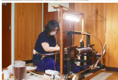
上_昔ながらの作業場で糸りをする様子 下_昔ながらの「いざり機」。経糸（たていと）と緯糸（よこいと）を手足を巧みに使って織り上げる
