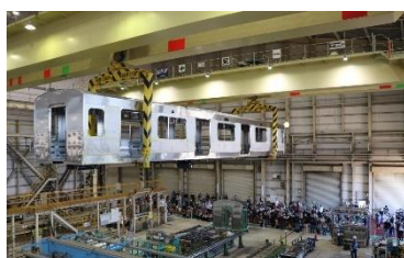
車体のクレーン移動
